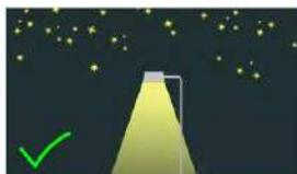
Les dispositifs d'éclairage de remplacement seront conçus de manière à éviter la diffusion de la lumière vers le haut. Les éclairages seront pourvus de dispositifs permettant de diriger les faisceaux lumineux uniquement vers le sol, ou mieux, vers la zone devant
